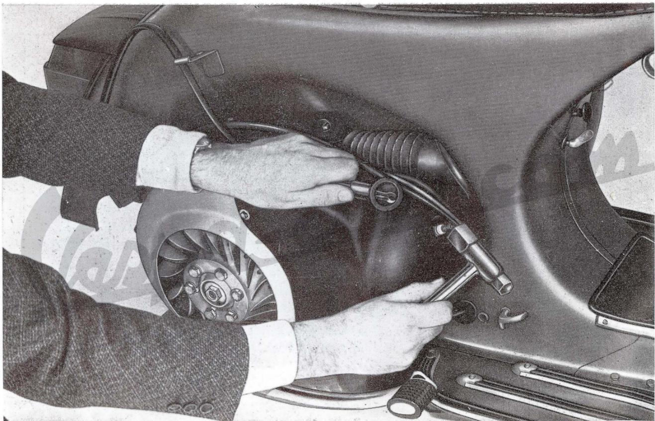
Fig. 16 - Démontage de la bougie — Abb. 16 - Ausbau der Zündkerze
